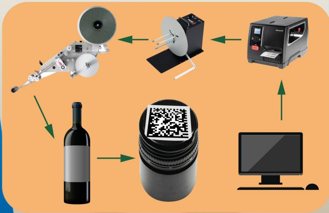
Печать DataMatrix на стикер d 20mm с зашифрованным числовым значением до 6 разрядов.
